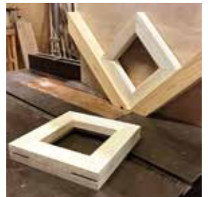
▲45度に端部をカットされ、裏側の溝も掘られた部材を接着して組んでいきます
